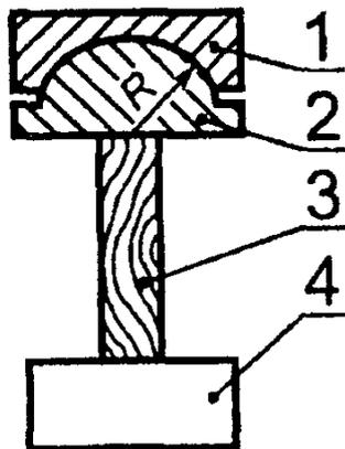
1, 2 — самоустанавливающиеся пластины; 3 — образец; 4 — нижняя платформа испытательной машины
